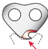
**Solução:** O elo de tração desgastou-se tanto que sua ponta atinge o fundo do pinhão. Substitua o pinhão. Afie as pontas das bases dos elos de tração, conforme exibido na ilustração da página 24, se possível. Caso contrário, substitua a corrente.
