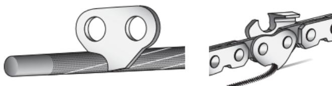
As pontas da base dos elos de tração ajudam a remover lascas e detritos da canaleta do sabre. Afie as pontas danificadas de modo que voltem a apresentar o formato original com uma lima redonda.
