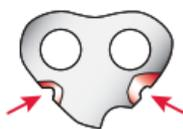
**Solução:** O pinhão de transmissão perdeu o passo por conta do desgaste. Substitua-o. Troque a corrente da motosserra. Não tente usar uma corrente nova em um pinhão de transmissão velho ou uma corrente velha em um pinhão novo.
