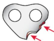
**Solução:** Remova os danos das laterais dos elos de união com uma lima chata. Afie as pontas da base dos elos de tração conforme exibido na ilustração da página 24. Utilize uma lima fina para abrir a entrada da canaleta do sabre.
