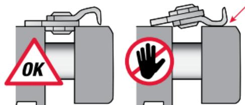
Al retirar remaches de eslabones rotos, sostenga los dos segmentos rotos juntos en su posición original (sin romper) mientras aprieta el eslabón de la cadena en el yunque ajustable.
