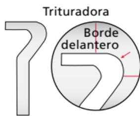
La **cadena de semicincel** es esencialmente un diseño de trituradora más estilizado. Presenta una placa superior cónica, una placa lateral destalonada y un radio menor hasta el borde delantero. Esto aumenta enormemente la eficiencia de corte sin sacrificar mucho la durabilidad.
