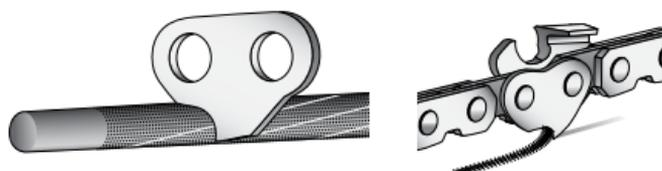
Las espigas puntiagudas de los eslabones ayudan a eliminar las virutas y los residuos de la ranura de su barra guía. Afile las espigas dañadas para restituir las a su forma original con una lima redonda.
