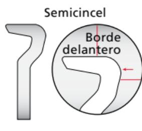
La **cadena de cincel** está diseñada para todo tipo de rendimiento de corte haciendo el borde delantero una esquina recta puntiaguda. La cuchilla cuadrada de la cadena de cincel corta además más rápido separando todas las fibras de la madera en el corte de una pasada. El borde delantero real del punto realiza la mayor parte del corte y se daña fácilmente en condiciones abrasivas. Como resultado, la cadena de cincel es idónea para la madera en pie, limpia.
