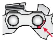
Granallado de las esquinas frontales de las cuchillas y los eslabones de unión
