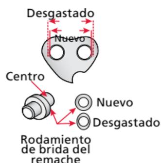
Una lubricación y un mantenimiento adecuados son esenciales para evitar un desgaste prematuro de la cadena. El desgaste de los eslabones de la cadena y los remaches (consulte la ilustración) se puede evitar con un mantenimiento y una lubricación adecuados de la cadena y la barra guía.
