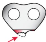
Partes inferiores dañadas o rotas
