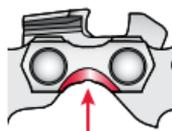
Granallado en las muescas de las cuchillas y los eslabones de unión
